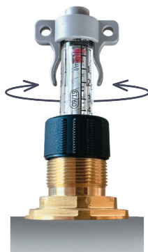
3 С помощью ключа, вращая колбу расходомера, выставить требуемое значение расхода теплоносителя (л/мин)
