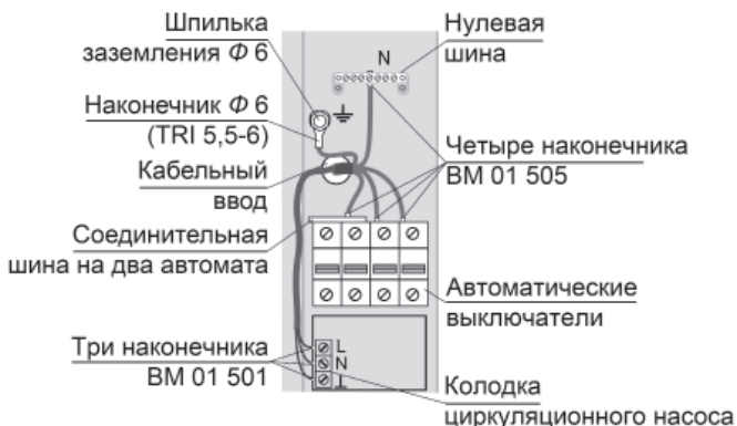
Рис. 5. Подключение РусНИТ 206К, 207К, 209К к трёхфазной сети
