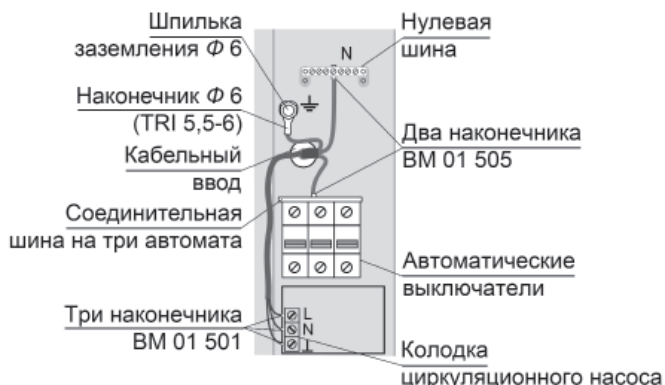
Рис. 3. Подключение РусНИТ 205К к однофазной сети
