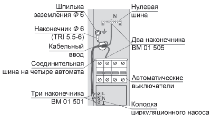
Рис. 4. Подключение РусНИТ 206К, 207К, 209К к однофазной сети
